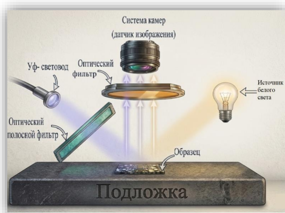
Рис. 3. Диаграмма системы визуализации бурового раствора.
