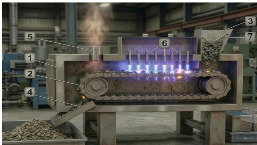
Рис. 14. Устройство плазменной витрификации бурового шлама.
