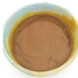
Рис. 3. Кристаллический продукт тетраценовой фракции, полученный после низкотемпературной кристаллизации при -5\text{ }^{\circ}\text{C} (масса 503 г).
